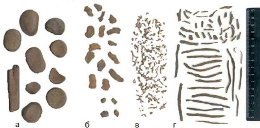
Рис. 1. - Металлические включения в песках спирального классификатора в цикле с мельницей МШР 3200х3100
