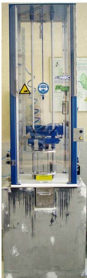
Рисунок 1. Схема устройства тестера падающего груза
