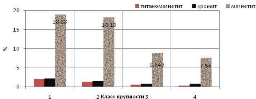
Рис.1. Распределение рудообразующих минералов по классам крупности: 1) -1,0+0,5 мм; 2) -0,5+0,2 мм; 3) -0,2+0,1 мм; 4) -0,1+0,071 мм
