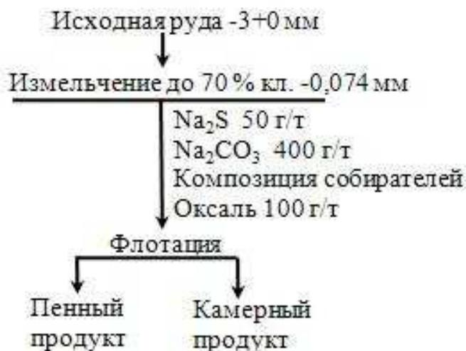
Рис. 1– Схема флотации
